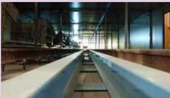
Le moule est ensuite transféré sur des rails jusqu'au tunnel d'étuvage, chambre isolée thermiquement et divisée en trois compartiments pour permettre au béton de sécher plus rapidement. Les voussoirs restent à l'intérieur pendant près de 6 à 7h, à des températures différentes pour favoriser la thermo-maturation.
