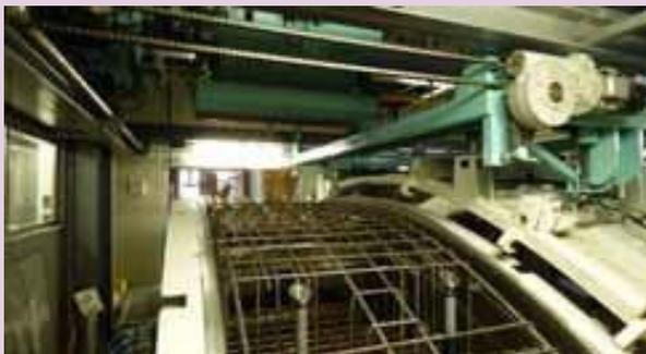
De la centrale à béton au poste de bétonnage, une benne achemine le béton au-dessus du moule à l'intérieur de la cabine de bétonnage. En moyenne, 3 m<sup>3</sup> de béton sont nécessaires pour couler un voussoir. Les vibrations du moule sont mises en route pour permettre une bonne répartition du béton et un meilleur enrobage des armatures. Vient ensuite le talochage manuel de la face supérieure du voussoir pour enlever l'excédent de béton.
