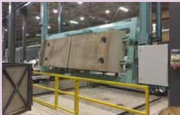
Le moule sort de la chambre d'étuvage. Un retourneur agrippe le voussoir sur les faces circulaires et le bascule à 180°, sur le dos. Le voussoir est alors placé sur une table d'évacuation et acheminé jusqu'au dispositif d'empilage, où il sera entreposé dans le hall de pré-stockage, à température ambiante durant 24 heures. Ce dernier est ensuite prêt à l'emploi.
