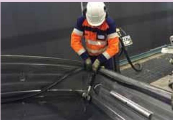
Un opérateur vient appliquer un joint compressible à l'intérieur du moule.
